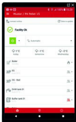
Vista de conjunto compacta con las informaciones más importantes. Posibilidad de asignar un nombre individual a los circuitos de calefacción.
